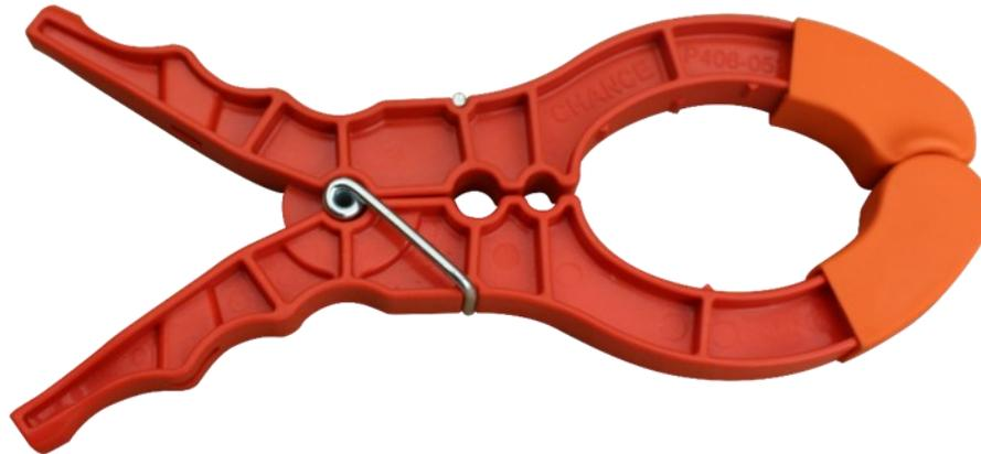
La Misión de las pinzas es la sujeción de las mantas dieléctricas, permitiendo aislar la zona de trabajo. Es recomendable utilizar al menos 4 de estas para evitar accidentes en caso de que alguna se suelte. La colocación de las pinzas siempre se debe realizar con los guantes dieléctricos o en su defecto con pértiga aislada.
